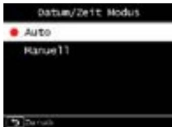
L'apparecchio è impostato in fabbrica in modo che l'ora venga impostata automaticamente. Se l'apparecchio è collegato a Internet tramite la rete, l'ora e la data vengono sincronizzate automaticamente. Non è quindi necessario impostare l'ora manualmente. È possibile modificare queste impostazioni in qualsiasi momento nel menu principale alla voce Sistema.
