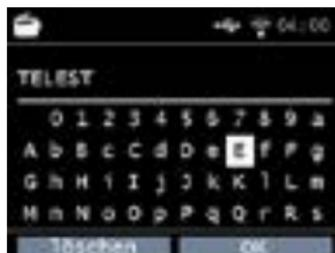
Inserire il nome della stazione radio nel campo di ricerca utilizzando la tastiera del telecomando. In alternativa, è possibile cercare anche l'URL, se lo si conosce. Per farlo, utilizzare i tasti ▲▼◀▶. Confermare l'inserimento premendo OK. La radio cercherà ora tutte le stazioni che corrispondono a questa voce. Utilizzare i pulsanti per selezionare una stazione e confermare premendo il pulsante sul dispositivo.
